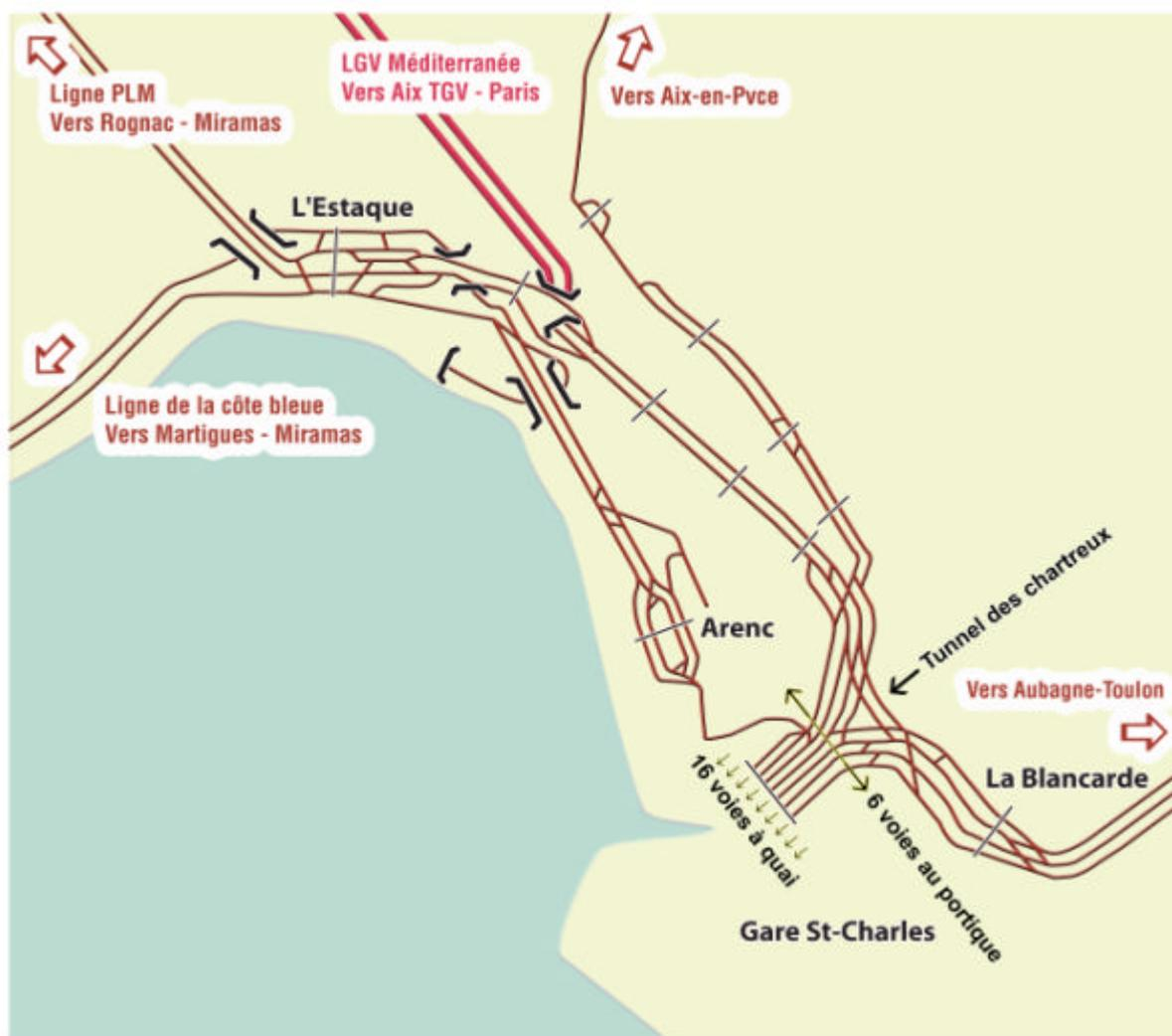
A l'horizon 2020, le plateau de Saint-Charles sera doté d'une exploitation par tubes. Cette attribution de groupes de voies à quai en fonction des provenances et destinations permettra de limiter les conflits entre les flux de chacune des trois branches de l'étoile marseillaise (voir schéma ci après).
