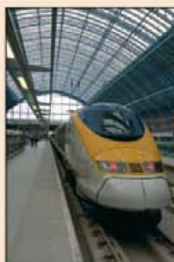
Construits entre 1993 et 1996, les TGV TMST étaient destinés à l'origine à traverser le tunnel sous la Manche pour son ouverture. Ils peuvent circuler en service commercial à la vitesse de 300 km/h.
