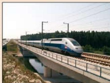
Les TGV POS peuvent circuler en service commercial à la vitesse de 320 km/h. Leur alimentation électrique est compatible avec trois types de courant : 1 500 V continu, 15 kV alternatif 16 2/3 Hz et 25 kV alternatif 50 Hz délivrés par caténaire.
