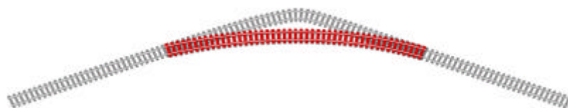
Figure 4 : La reprise d'une seule courbe permet d'augmenter la vitesse sur la totalité de l'itinéraire
