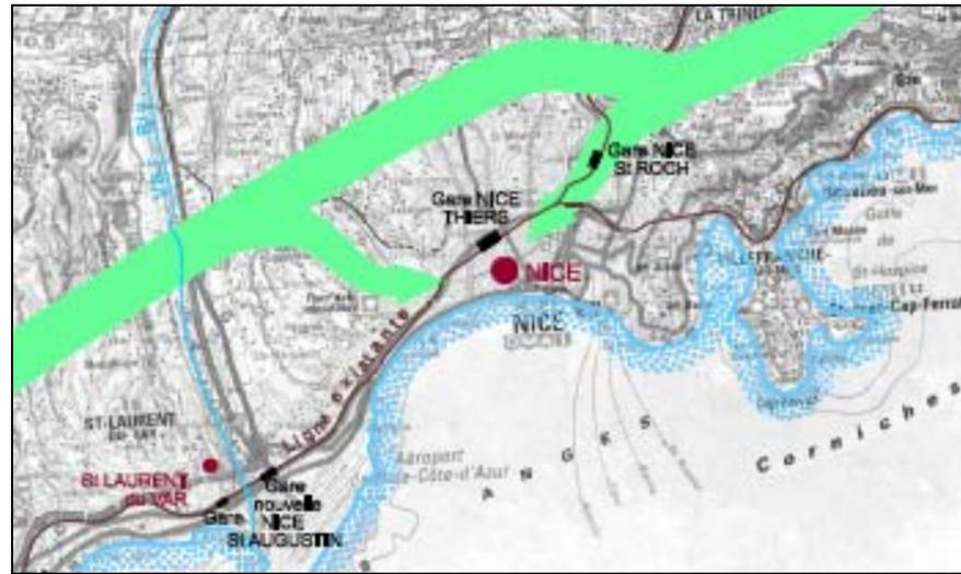
Ce raccordement dénivélé rejoint la voie ferrée directement dans le faisceau de la gare de Nice-Thiers. Il s'agit de chercher à rapprocher la grande vitesse du centre de Nice.
