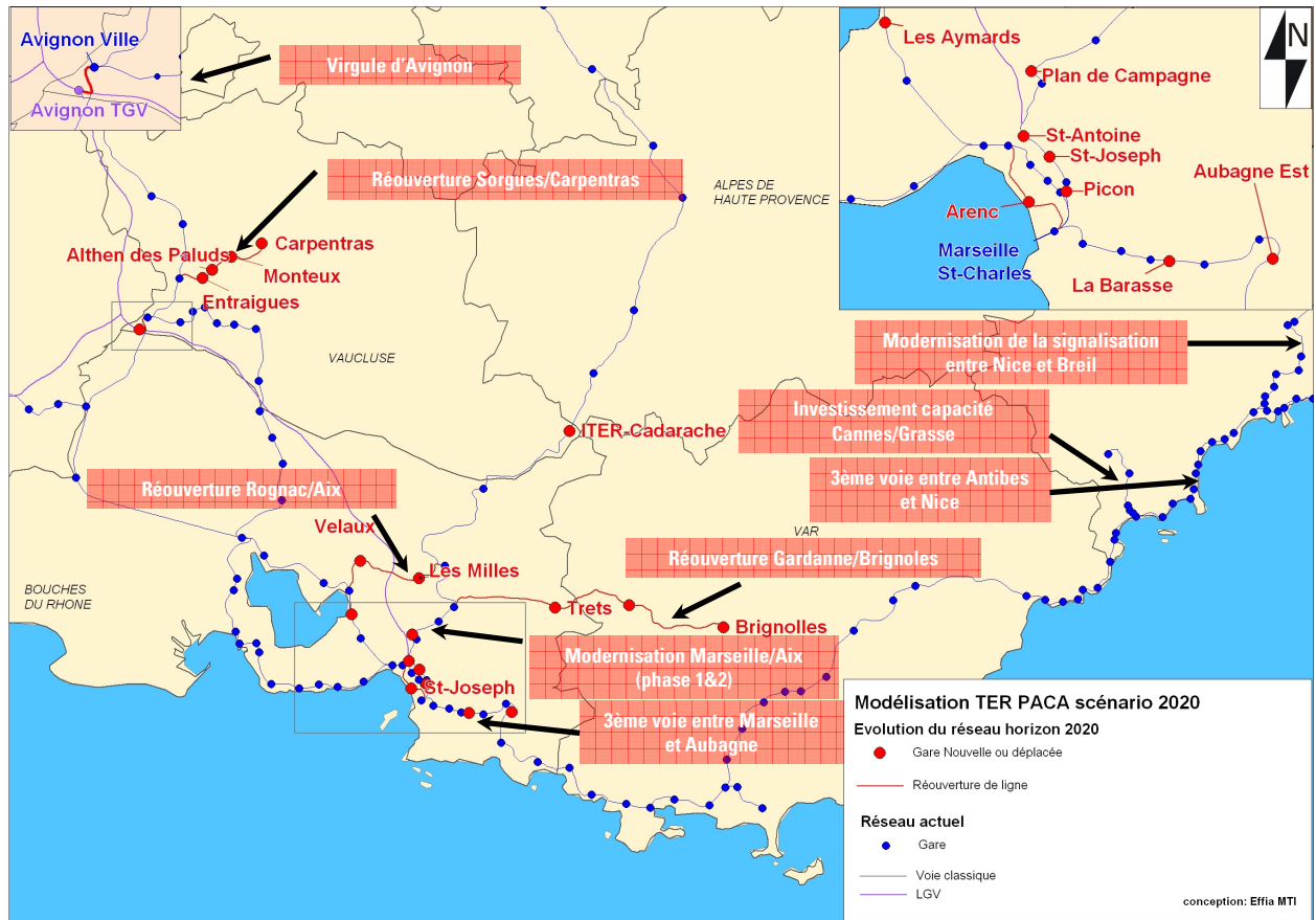
Figure 10 : Les infrastructures ferroviaires à l'horizon 2020
