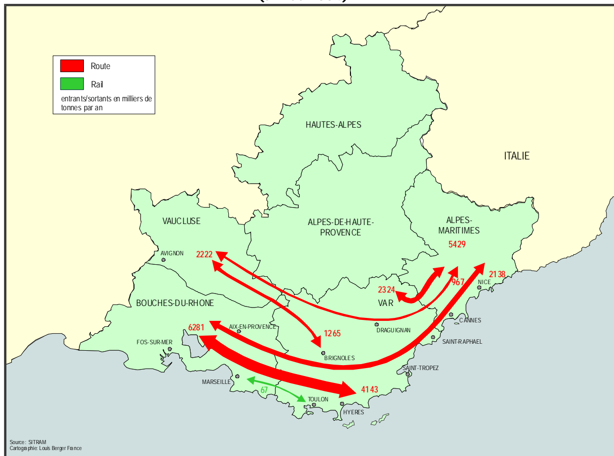
Figure 13 : Flux internes à la région PACA potentiellement concernés par le projet de LGV (année 2004)
